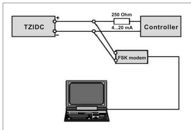
图6：通过信号线用FSK modem进行HART通信
